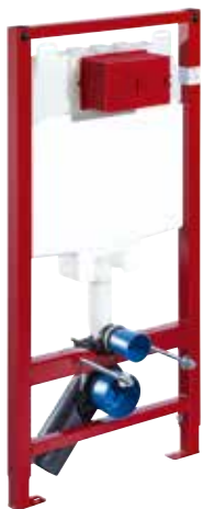
Modul WC MONTUS (tip C 80) BH 115 cm cu rezervor de spălare ST 8 cm Montajul uscat
