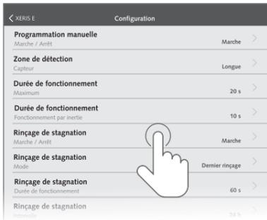
» Sélectionner le paramètre souhaité dans le menu de réglage et l'enregistrer dans le robinet avec « Enregistrer ».
